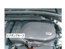
フィルターカバーをビスAで取り付け、配線カバー エアポンプホースを元に戻します。
