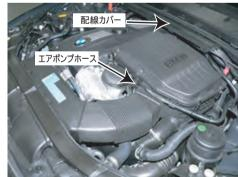
エアポンプホースを矢印のところから一度外します。 エンジン上部にある配線カバーもフックを外して、 フリーにして作業を行ないます。
