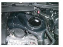
エンジンルームに配置して、インテークホースに それぞれ挿し込み、バンドで締めます。 ラバーマウントの位置を合わせて、挿し込みます。
