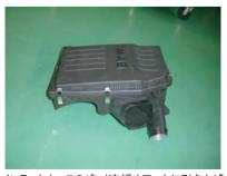
ノーマルの導入ガイド、サクションダクトを外します。インテークホースのバンドを緩めて、上に引き上げ (ラバーマウント3箇所で固定されています)
