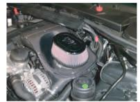
チャンバーボックスにフィルターを取り付け、 バンドで締め付けます。
