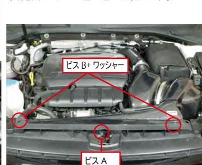
14. 導入ダクトをビスA×1と、ビスBにワッシャーを挟み固定します。（2箇所）
