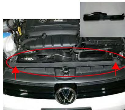
3. 矢印のビスを取り外し純正導入エアガイドを外します。
