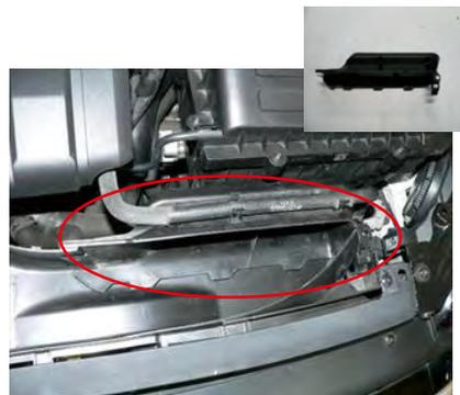
2. ラジエーターホースを外します。赤丸の純正導入エアガイドを外します。
