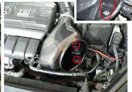
9. チャンバーケースを固定用ニップルに差し込みます。その時ケース内のゴムプッシュが脱落していないか、必ず確認してください。
