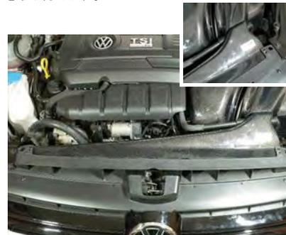
13. フィルターケースに導入ダクトが刺さるようにして車両に配置します。コルゲートチューブ（長）は導入ダクトの溝に入ります。
