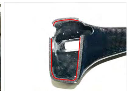
12. パッキンテープを適切な長さにカットして導入ダクトに貼り付けます。
