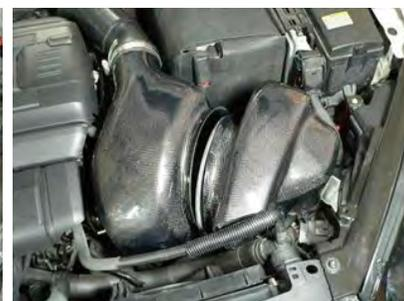
11. フィルターをフィルターケースに入れて車両の固定用ニップルに差し込み配置します。
