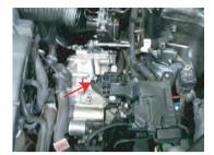
クリーナーボックス下の樹脂ブラケットの 矢印ナットを外します。(ここにステーを 取り付けます。)
