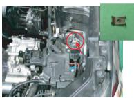
矢印部にM4クリップナットを挟み、 取り付けます。
