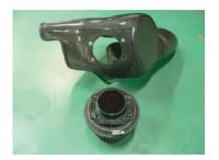
フィルターにファンネルアダプターを取り付け、 その上にジョイントアダプターを乗せます。
