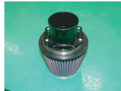
ファンネルアダプターにフィルターを取り付けます。その上にジョイントアダプターを乗せます。
