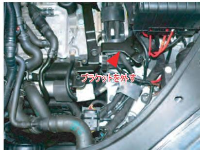
配線クリップを外して、ノーマルクリーナーケースの固定ブラケットを取り外します。配線クリップはヒューズBOXの下にあります。
