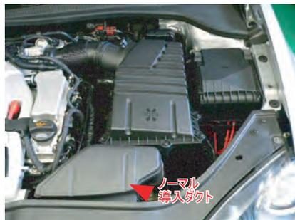
上蓋を外して、ノーマル導入ダクトを外します。(トルクスのタッピングビスで固定されています)
