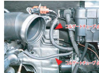
エアフロメーターの配線とその他の配線を分けて、付属のコルゲートチューブを巻き、タイラップで留めます。
