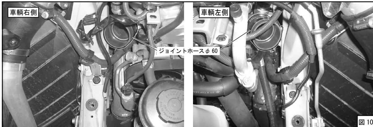
(4) エアフロメータセンサのリング(純正)がサクシオンパイプに噛み込まないようにしながら、キットパーツのM4ビス、M4カラーを使用して取付けてください。この時ビスを締めすぎないようにしてください。[2組]
