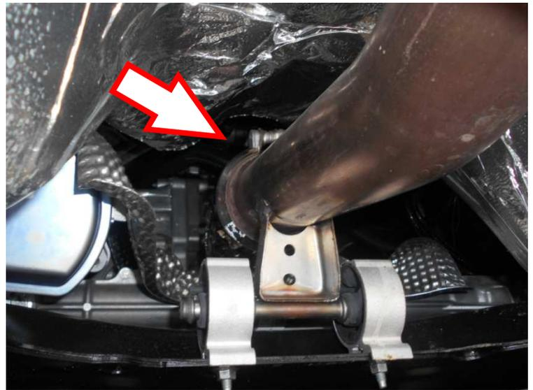
Die Querstrebe demontieren, die Aufhängungsgummis aushängen und die serienmäßige Abgasanlage abnehmen.
