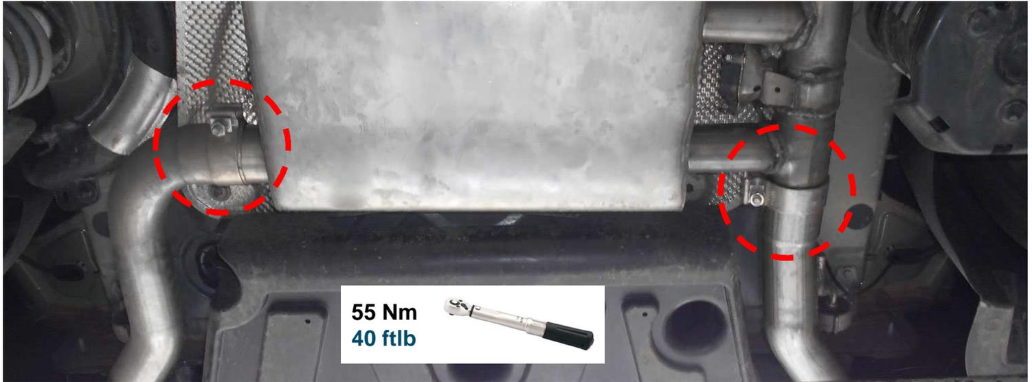
Klemm- oder Schraubverbindungen locker vorziehen. Den REMUS Sportschalldämpfer ausrichten und die Verbindungen fest anziehen. Motor kurz anlassen und den kompletten REMUS Sportschalldämpfer auf Dichtheit überprüfen. Sämtliche Bauteile, sowohl im kalten als auch im betriebswarmen Zustand auf Funktion und genügend Freigängigkeit überprüfen. Achten Sie dabei auf einen ausreichend belüfteten Montagebereich.
