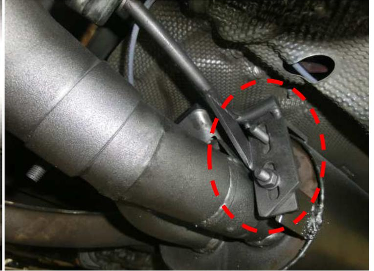
Das REMUS Verbindungsrohr am Serienrohr montieren. Das REMUS Racingrohr am Verbindungsrohr montieren. Die Gummiaufhängung am Befestigungspunkt der Karosserie einhängen.
