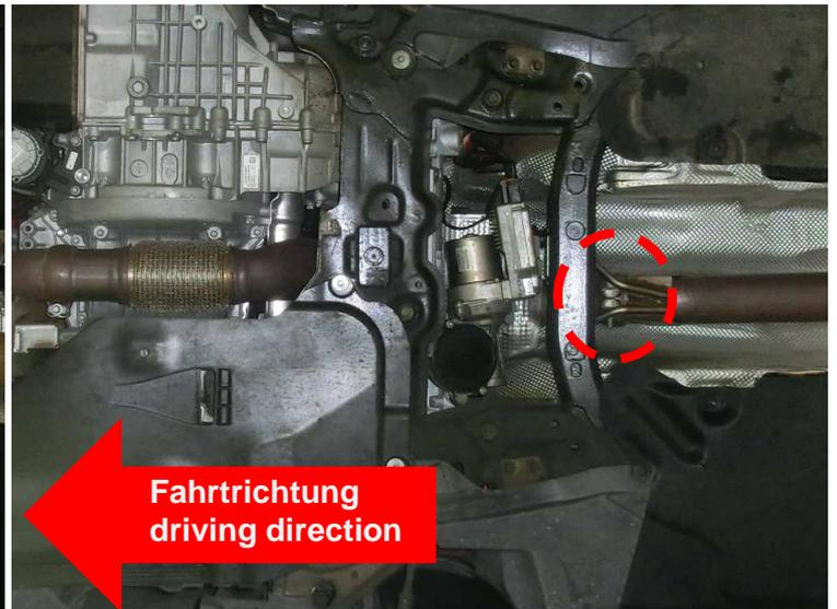
Den Aktuator der Klappensteuerung abschließen, die Aufhängungsgummis aushängen und die serienmäßige Abgasanlage abnehmen.
